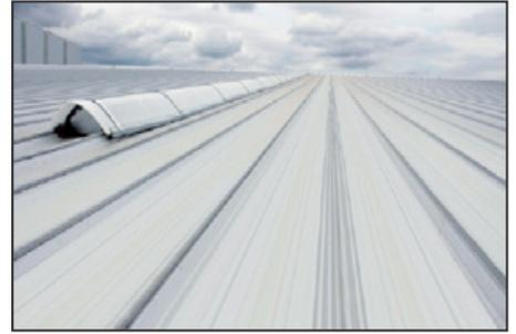
Recomendado para obras de pequeno à grande porte, o sistema de cobertura zipada BRAZIP, representa a evolução em tecnologia para cobertura plana de baixa inclinação. Sistema composto por telhas contínuas, interligadas lateralmente através de zipagem mecânica de suas abas, fixada às longarinas da estrutura, através de clip's deslizantes, garantindo 100% de estanqueidade.
